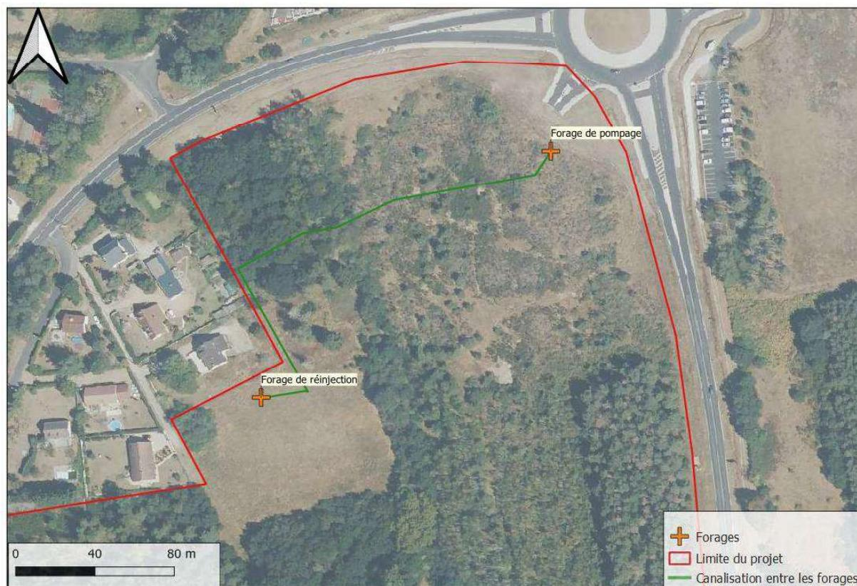
Figure 13 : Localisation prévisionnelle des forages de pompage, de réinjection et des canalisations
